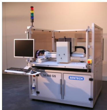
Messautomat für große Substrate
